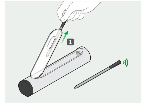
**4.** Abre el cargador y retira el termómetro. Al retirar el termómetro del cargador, el LED parpadeará en verde, indicando que el cargador está conectado al termómetro.
